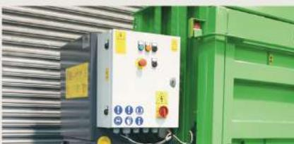
Bloque de alimentación externo para facilitar las reparaciones y el mantenimiento
