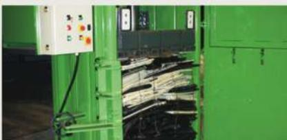
Ariete de carrera extralarga y dedos de extrarretención para una compactación óptima y un atado resistente con flejes
