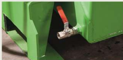
Tanque de retención de hasta 40 litros de líquido con grifo de salida
