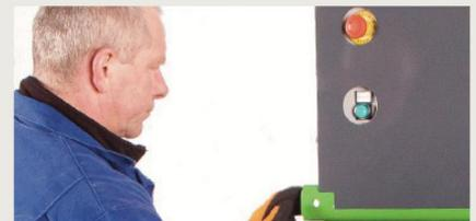
Controles de bajo voltaje para el operario y parada de emergencia para una mayor seguridad, así como ciclos automático y manual opcionales
